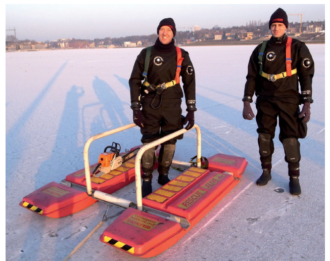
Dieser Spezialschlitten ist ein wichtiges Hilfsmittel, mit dem Mitarbeiter der Feuerwehr im Notfall Menschen retten können, die in das Eis eingebrochen sind. Fotos: Stadt Dortmund
